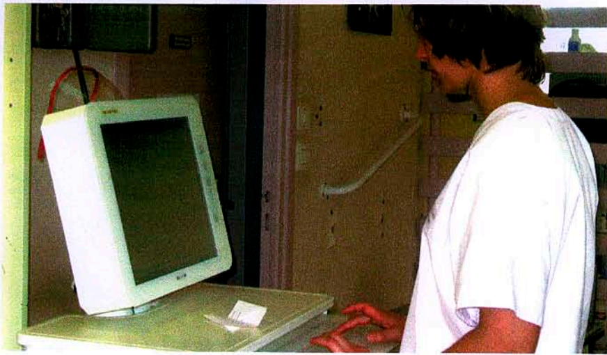
Le chariot informatique intègre un écran et un clavier en verre trempé facilement désinfectables.
